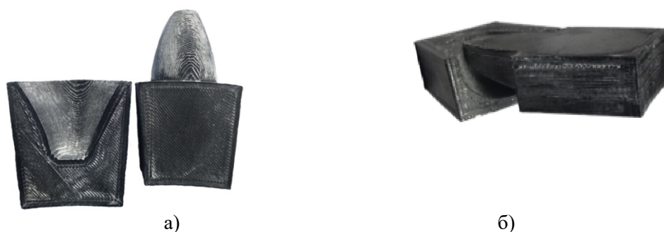
Рисунок 5 – Зображення надрукованих на 3d-принтері з пластику фрагменти зубозаокруглюючої впадини та торцевої поверхні зубця: а – деталі розміщені окремо; б – деталі знаходяться в зачепленні Figure 5 – Image of the fragments of the tooth-rounding cavity and end surface of the tooth printed on a 3d-printer from plastic: a – details are placed separately; b – the parts are engaged
