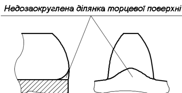
Рисунок 13 – Недозаокруглена торцева поверхня зуба Figure 13 – Underrounded end surface of the tooth
