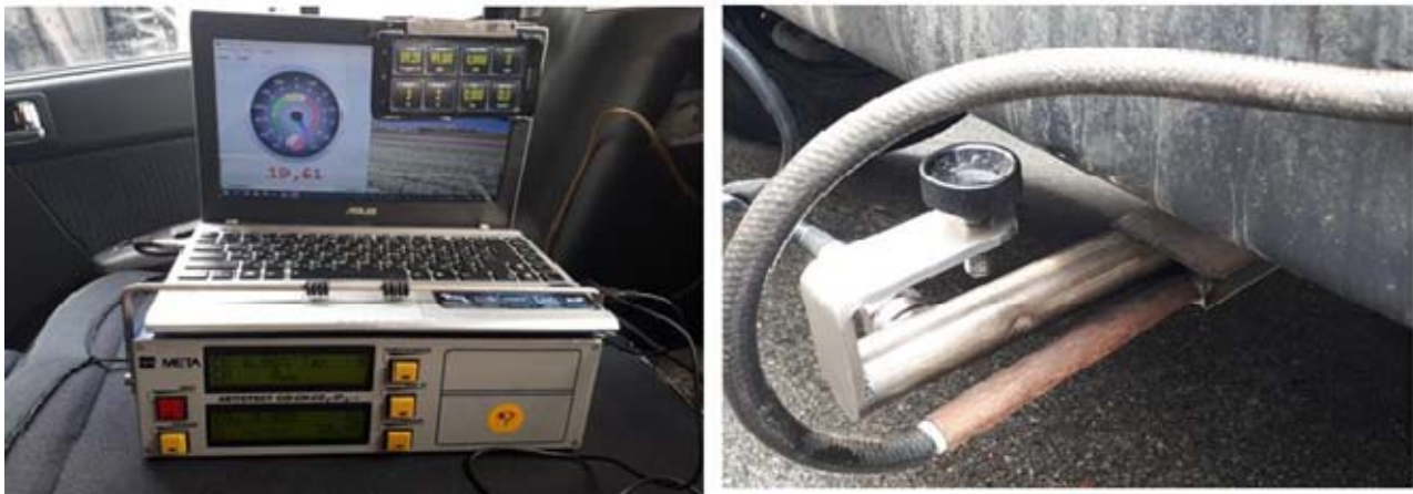
Рисунок 1 – Апаратура контролю параметрів двигуна та токсичності відпрацьованих газів Figure 1 – Equipment for monitoring engine parameters and exhaust gas toxicity
